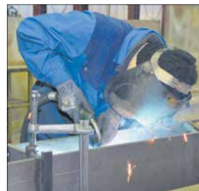
Beim Schweißen erreicht die Temperatur rund 3200 Grad.
